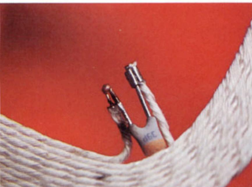
Fig.9E. Das Spulendrahtende und der Anschlussdraht des Kondensators werden direkt zu einem Kupferkugeln verschmolzen. Die wegen der Baumwollgewebeisolation schwierige Crimpverbindung (rechts) kann durch Verschweißen ersetzt werden.
