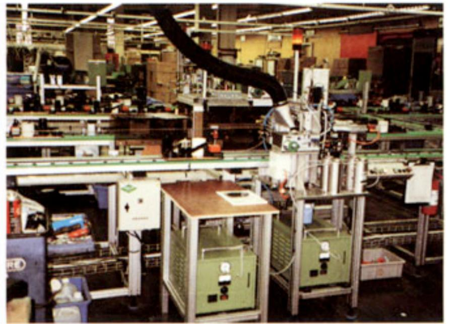
Fig.7B. Jedes der zwei SPIRFLAME® speist eine Flamme zum automatischen Einlöten eines Heizspiralenanschlusses in ein Haushaltsgerät. Jede Lötstelle wird von je einem Lotdrahtvorschub LD-200SS bedient.
