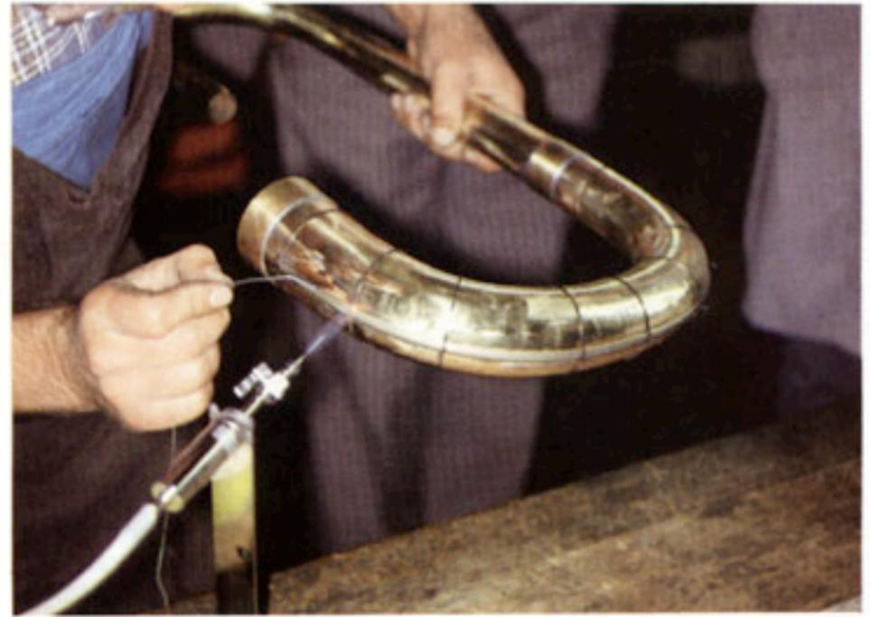
Fig.11B / 11C. Die Niedertemperatur - <spirflamme> (spezielles Additiv im BOOSTER) verfärbt beim geschickten Reparaturlöten selbst versilberte, vergoldete oder sonderlackierte Oberflächen kaum oder gar nicht.
