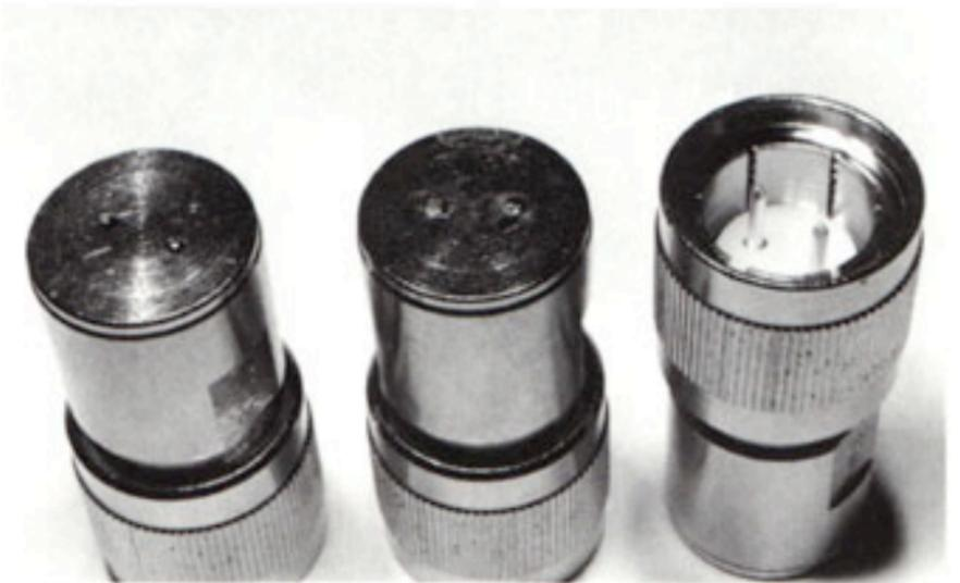
Fig. 7D. Die Abschlusswiderstände in Koaxialendsteckern sind mit den massiven Steckerstirnplatten zu verlöten. Die konzentrierte und rasch übertragene Hitze der <spirflamme> ist auch hier wieder ein sehr geeignetes und geschätztes Werkzeug.
