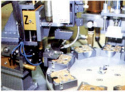
Fig.3A. Das automatische Weichlöten auf "Gedruckten Schaltungen" ist eine Standardanwendung der SPIRFLAME®.
