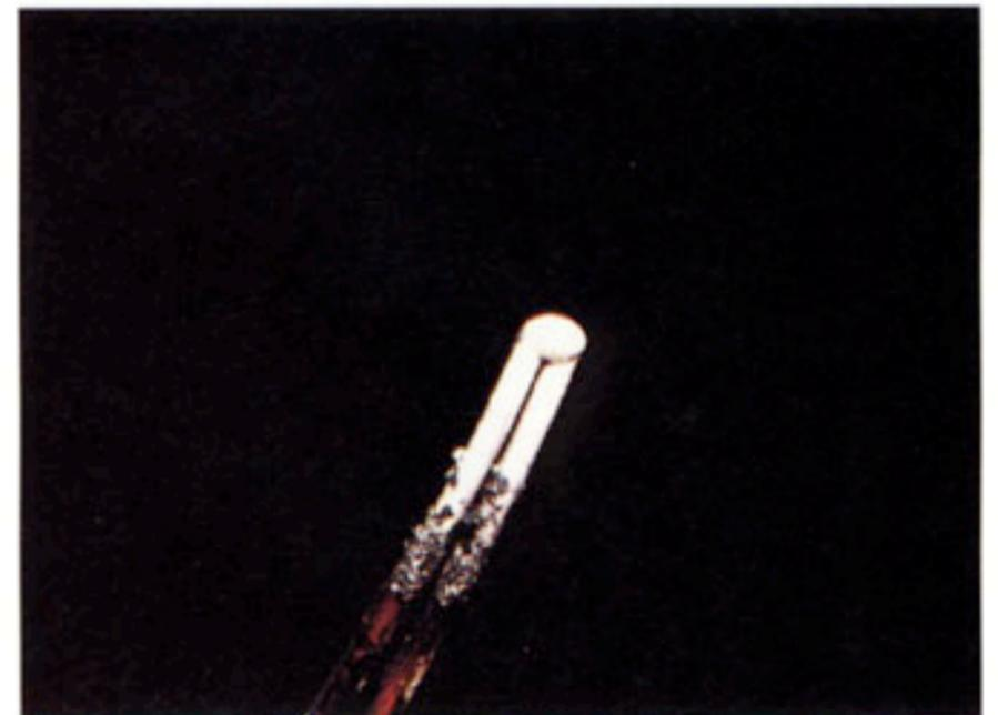
Fig.9F. Zwei Lackdrahtenden werden parallel fixiert und zusammengeschweisst. Die saubere, glatte und oxydfreie Schweissperle deutet auf eine hohe Güte hin.
