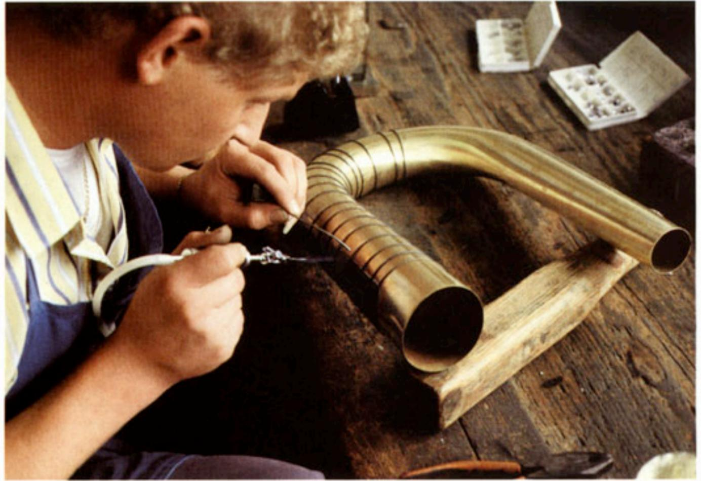
Fig.11A. Die Herstellung und Reparatur von Blechblasinstrumenten verlangt ein gerütteltes Mass an handwerklichen Fertigkeiten im Umgang mit dünnen Blechmaterialien. So ist es in diesem Metier selbstverständlich nur hochqualitative Materialien, Werkzeuge und Verfahren einzusetzen. Die leicht regulierbaren und stabilen <spirflammen> finden besondere Schätzung in diesem Berufszweig.
