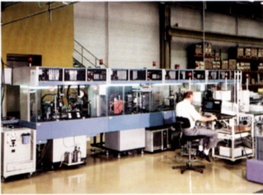
Fig.7A. Ansicht einer vollautomatischen Montagelinie für Magnetspulen. Siehe auch Fig. 6A / 6B / 8A. Links ist ein auf die Montagelinie farblich abgestimmtes, grau gespritztes, altes SPIRFLAME® Modell 500HP zu sehen. Das heutige Nachfolgermodell 505HP ist wesentlich kompakter gebaut.
