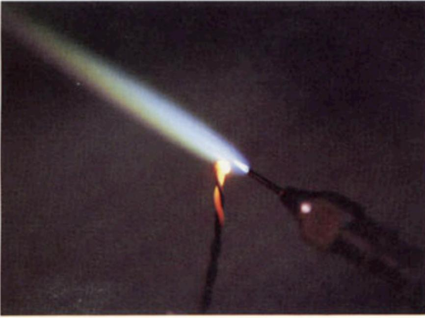
Fig.9A. Die Hitzezone der <spirflamme> zerstört und verdampft hochtemperaturfeste Lackisierungen. Die verdrehten Drahtenden verschmelzen zu einer glatten Kugel.
