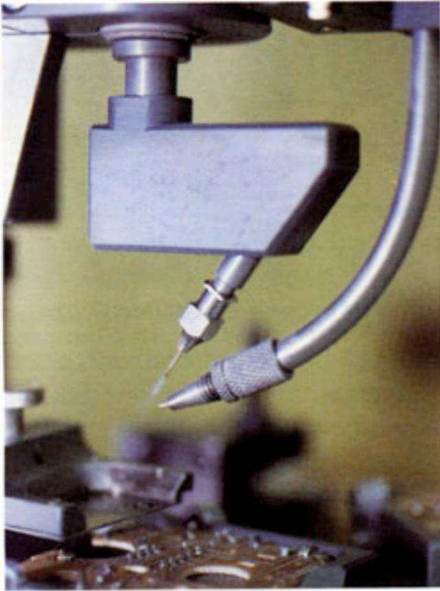
Fig.4A. Detailansicht eines Mikro-Flamm-Lötkopfs einfacherer Bauart. Die gegenseitige geometrische Lage der Flamme und des Lotdrahtvorschubes ist weitgehend verstellbar.
