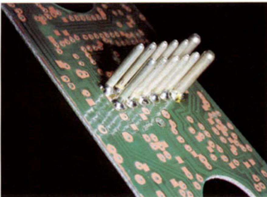
Fig.6E. In den Print eingepresste, massive, versilberte Kontaktstifte werden auf dem für automobiler Zwecke eingesetzten Print mit den Lötäugen verlötet. Wellenlötanlagen liefern zu wenig Wärme für solche massive Teile. Mit SPIRFLAME® werden bei richtiger Einstellung kalte Lötstellen **gänzlich** verhindert.
