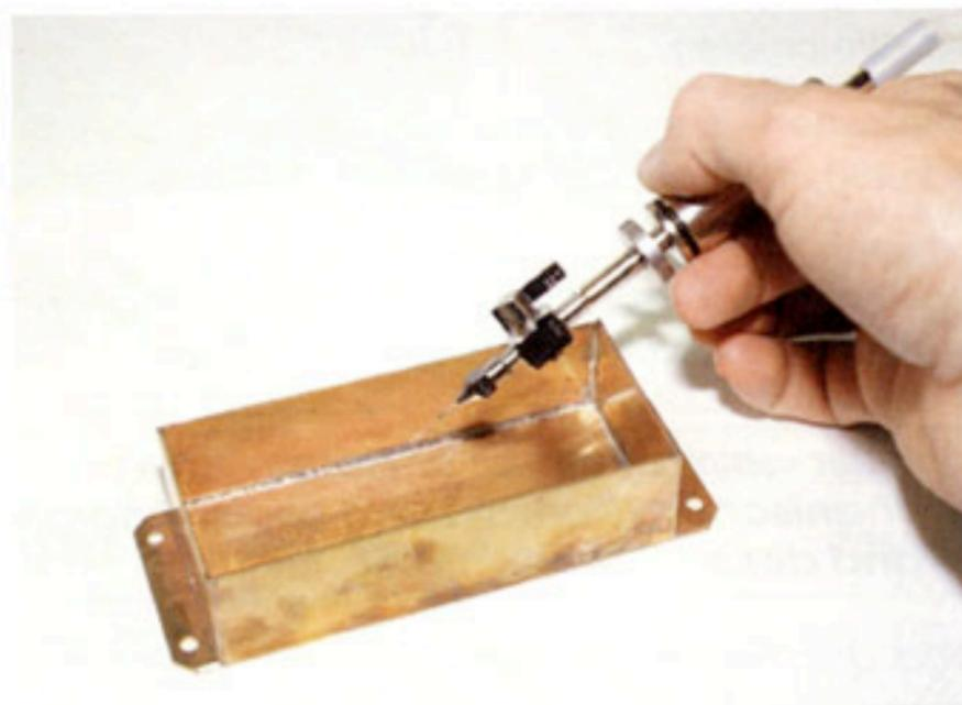
Fig.4E. Mehrere Messingblechteile (1-2 mm dick) werden in Handarbeit rasch und präzise zu einem HF-dichtem Abschirmgehäuse zusammengelötet.
