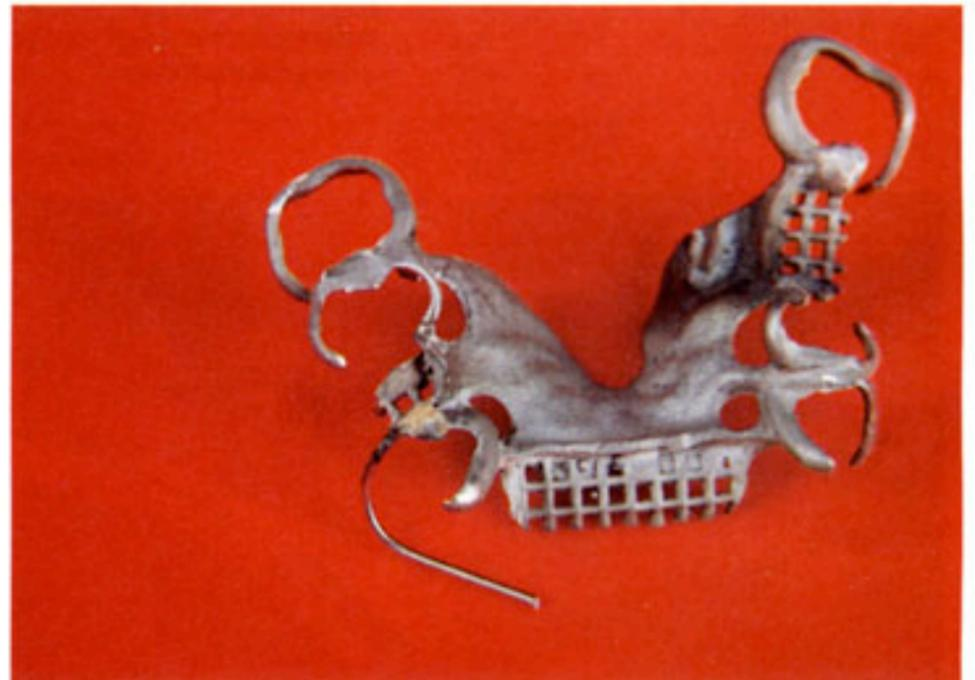
Fig. 12B / 12C / 12D. Verschiedenste Dentaltteile werden bei der Herstellung und beim Reparieren mittels Gold- oder anderen Edelmetallloten zusammengefügt. Eine kräftige, aber trotzdem hitzezonenbegrenzte Mikroflamme ist dabei sehr hilfreich.
