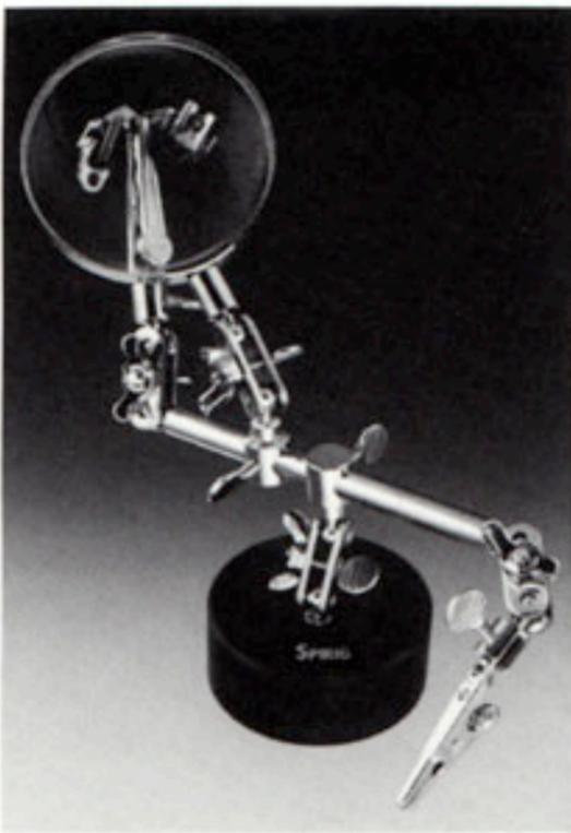
Die **X-PLATE®** ist eine flexible Vorrichtung mit verschiebbaren Klemmpinzetten zum Löten. Die hitzefeste Arbeitsplatte ist aus einem asbestfreiem Material.
