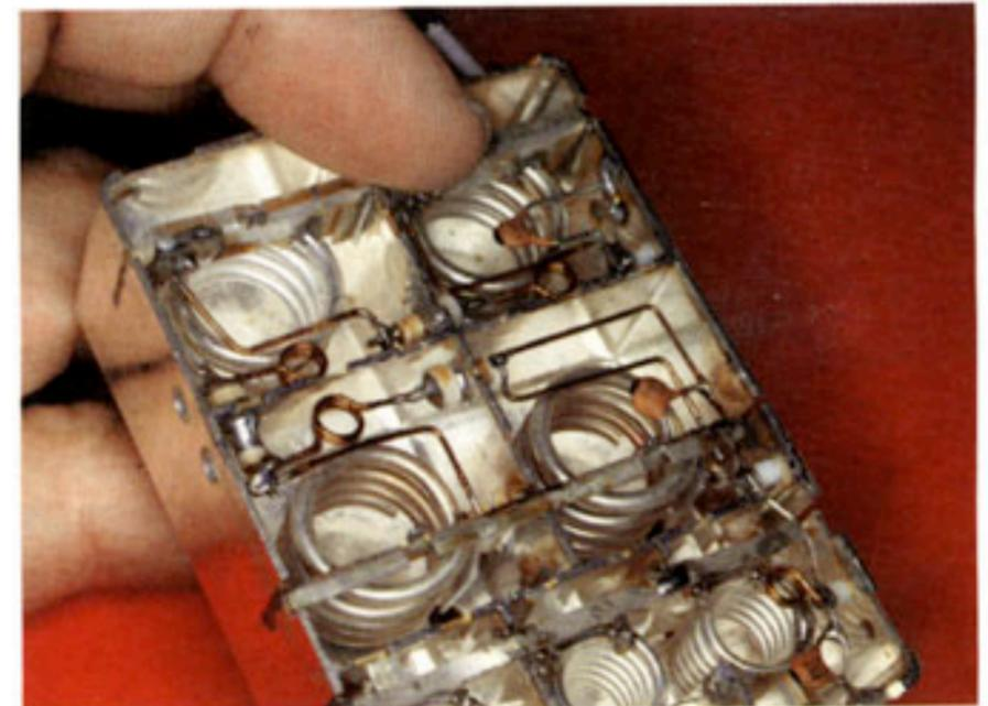
Fig.4F. In Hochfrequenz-Modulen sind versilberte Blechteile, Spulen und Durchführungskondensatoren weich zusammenzulöten. Das Mikroflammlöten ist für eine thermisch schonende und sehr rasche Verlötung besonders gut geeignet. Die Erwärmungszone ist begrenzt. Bereits gemachte Weichlötungen werden bei geschicktem Vorgehen nicht wieder gelöst.
